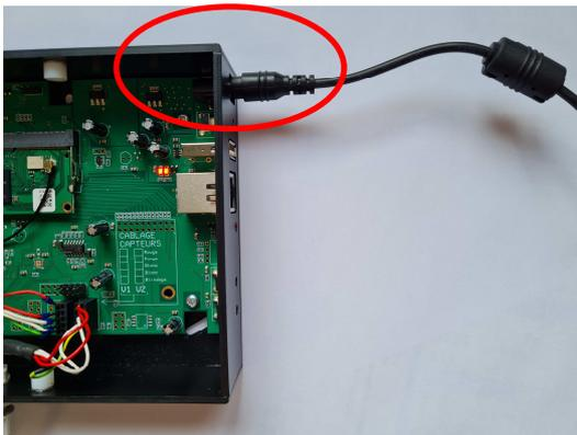
**1- Raccordement de l'alimentation sur le boîtier, via la prise Jack**
