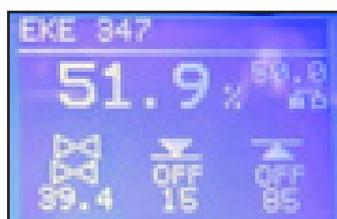
L'affichage par défaut de l'EKE esclave indiquera le niveau de liquide réel (comme le maître), un symbole représentant plusieurs vannes, le degré d'ouverture total réel et le degré d'ouverture des différentes vannes utilisées (voir ci-dessous).
