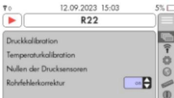
Die Rohrfehlerkorrektur ist eine Temperatur-Korrekturfunktion welche den Messfehler vom Rohr zum Kältemittel kompensiert.
